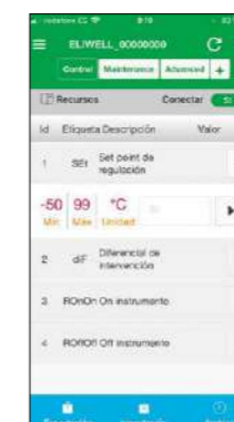
Acceso a parámetros básicos configurados en pestaña «control».
